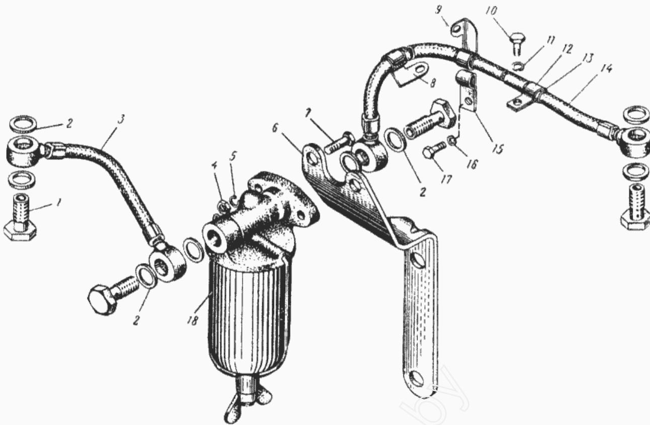
Рис. 23. Топливные трубопроводы
