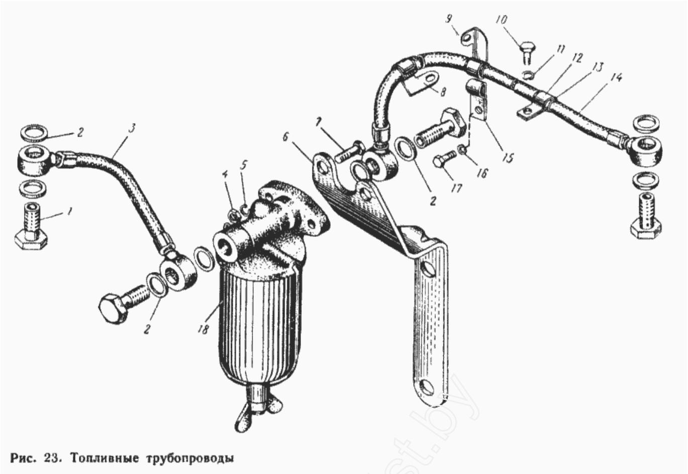
Рис. 23. Топливные трубопроводы
